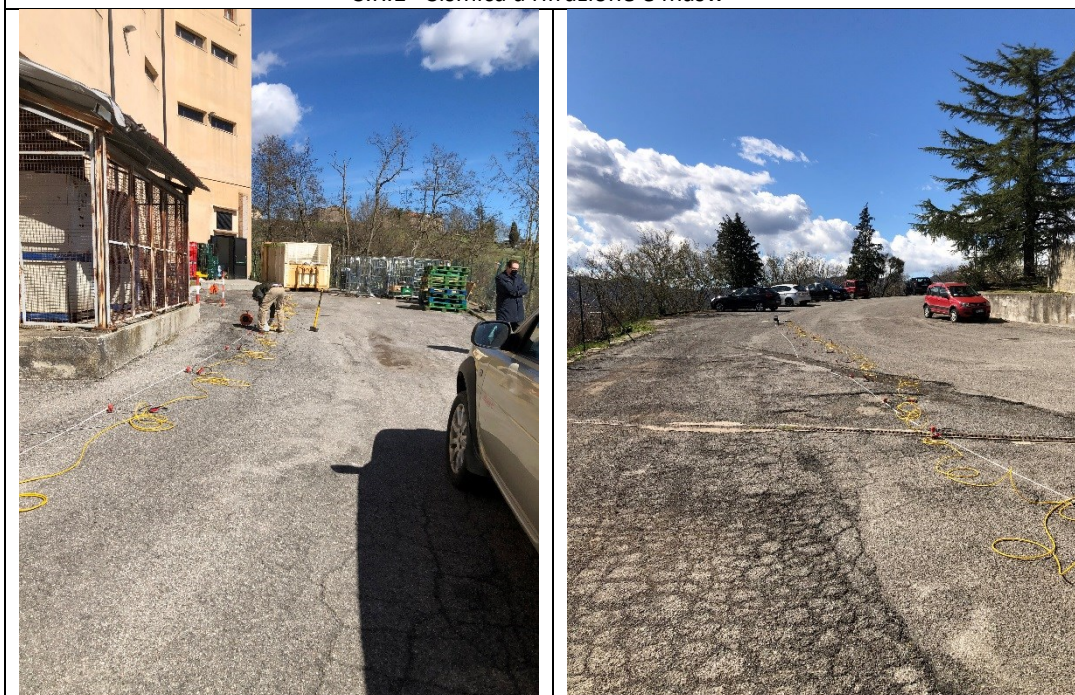
S.R.1 - Sismica a rifrazione e masw
