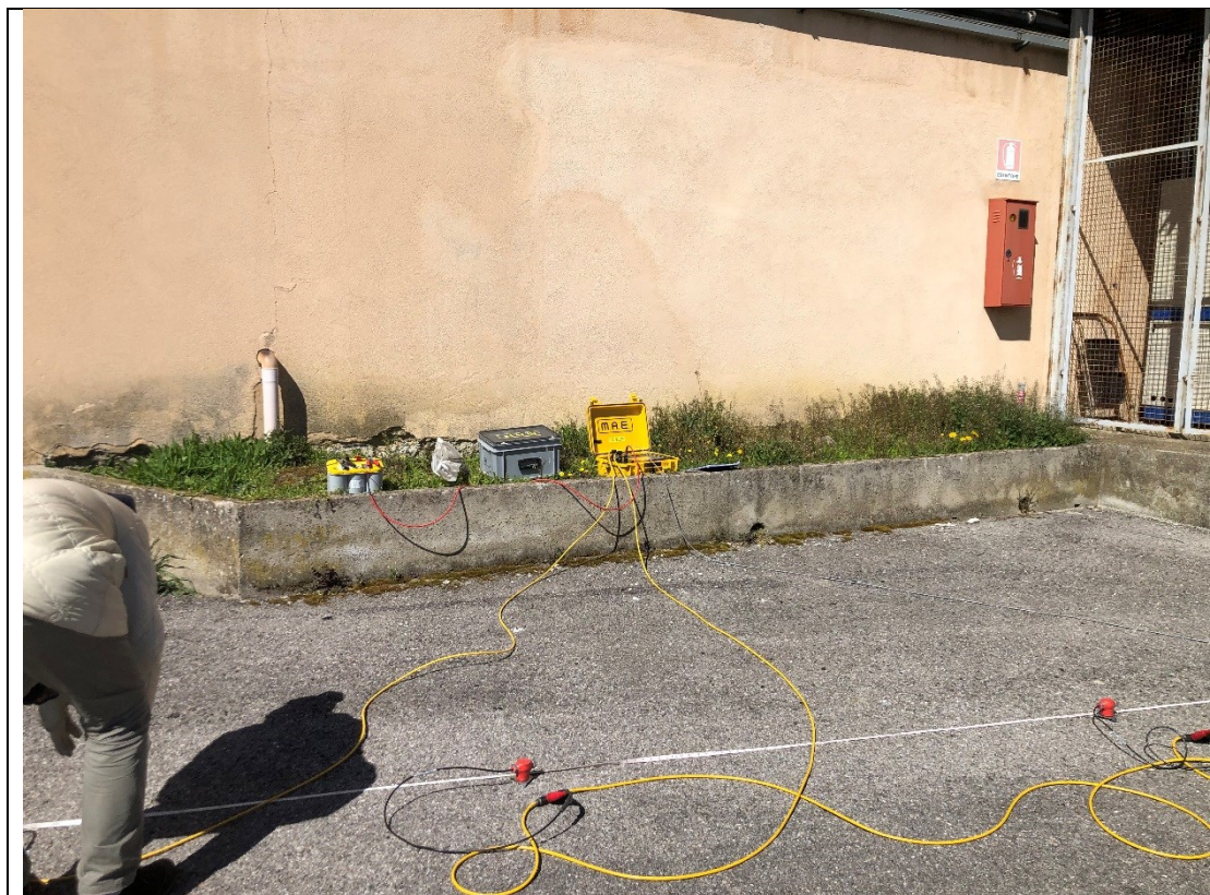
S.R.1 - Sismica a rifrazione e masw
